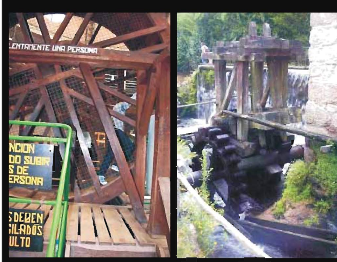
Roda hidráulica de tracción humana que se empregaba nas minas para evacuar as augas e evitar así as inundacións. O exemplar está no Museo da Minería de El Entrego, Asturias. Fonte: Leal.
